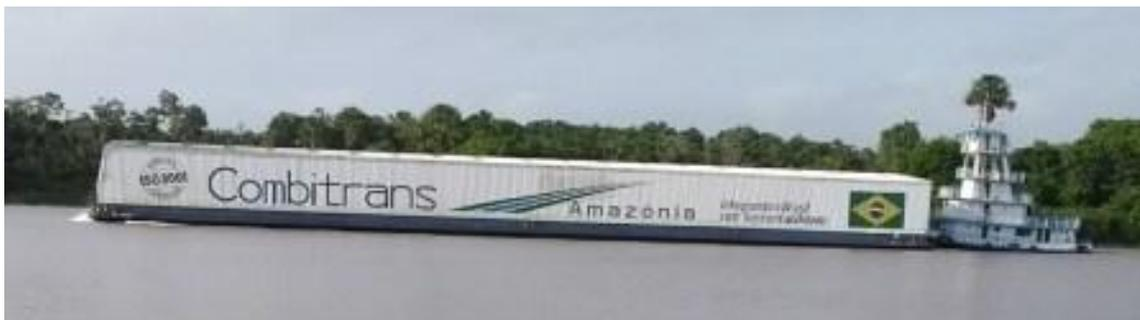
Figura 31 – Balsa SW – armazéns flutuantes
