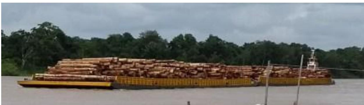
Figura 30 – Balsas sem cobertura para transporte de madeira em toras
